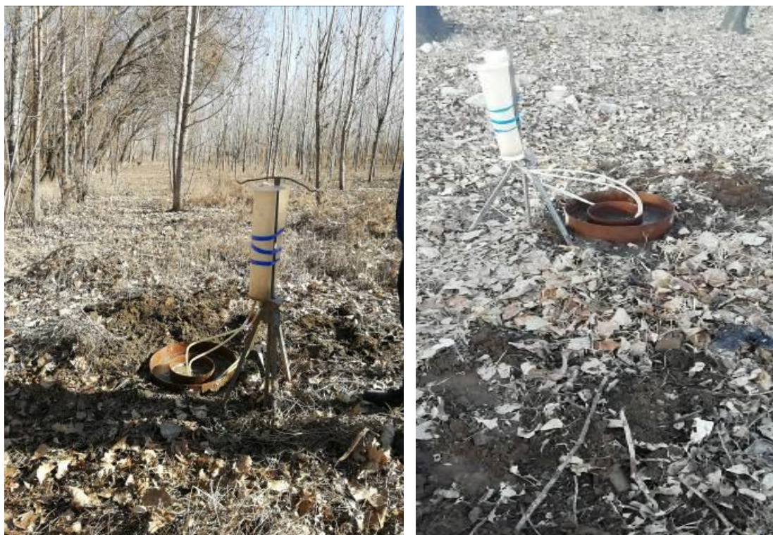
图4.2-12渗水试验现场照片
